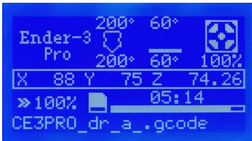
Slika 32. Prikaz zaslona pisača Creality Ender 3 pro, Izvor: vlastiti izvor
