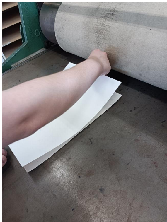
Slika 29 Stavljanje vlažnog papira na pločicu i paser
