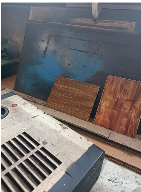
Slika 11 Prekrivanje pločice s lakom i sušenje pločice
