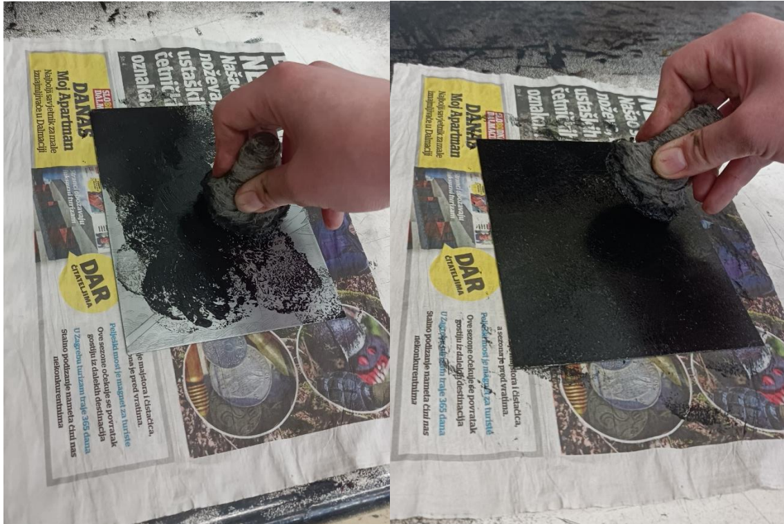
Slika 26 Nanošenje boje na pločicu
