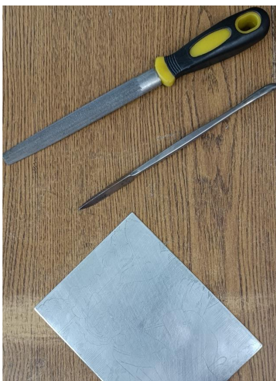
Slika 25 Alati za brušenje rubove i pravljenje faseta
