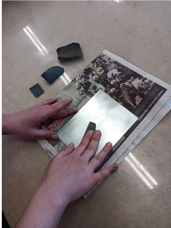
Slika 10 Brušenje pločice s brusnim papirom
