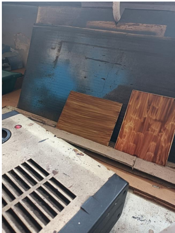
Slika 11 Prekrivanje pločice s lakom i sušenje pločice
