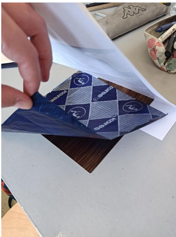
Slika 12 Stavljanje indigo papira na premazanu pločicu i ispod skice
