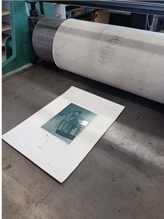
Slika 28 Stavljnje pločice na radni stol preše i na paser
