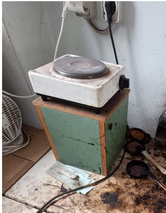
Slika 21 Pečica za pečenje nanesenog praha na pločici
