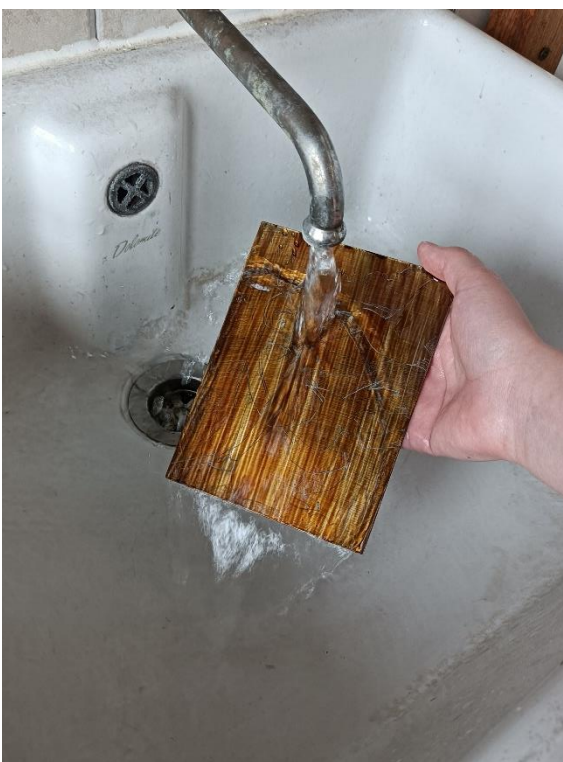
Slika 17 Ispiranje izjetkane pločice
