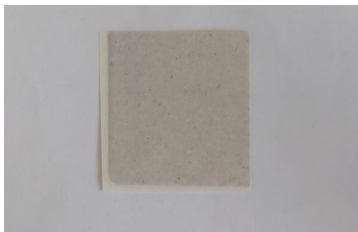
Slika 11 uzorak od 15% ostataka ječma otisnut reverzibilnom termokromnom bojom
