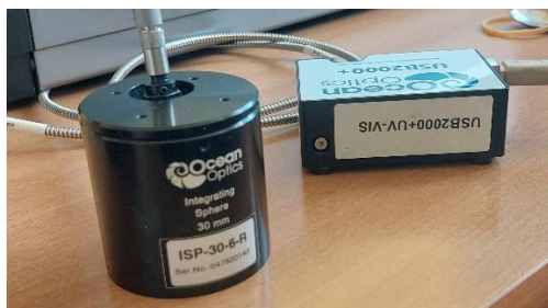
Slika 13 Ocean Optics USB2000+ spektrofotometar
