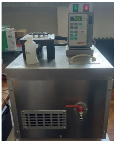
Slika 16 uređaj za zagrijavanje/hlađenje uzoraka
