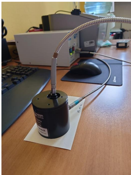
Slika 16 Spektrofotometar Ocean Optics USB 2000+
