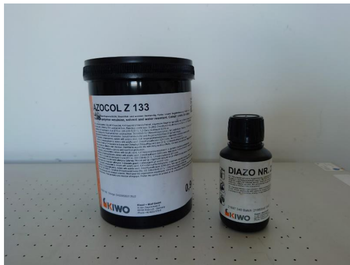
Slika 20 Komponente za fotoosjetljivu emulziju (Azocol Z 133, Diazo NR.23)
