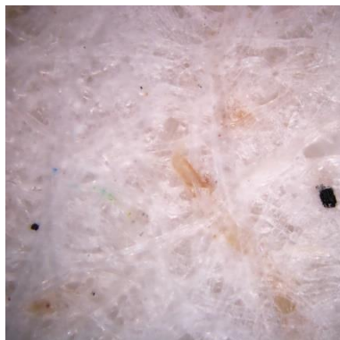
Slika 25 Tiskovna podloga s udjelom kave pod povećanjem 20 puta
