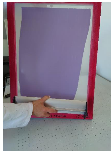
Slika 7 Oslojavanje mrežice fotoosjetljivom emulzijom
