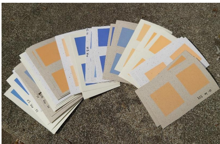
Slika 42 Otisci izloženi sunčevoj svjetlosti
