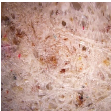
Slika 24 Tiskovna podloga s udjelom trave pod povećanjem 20 puta
