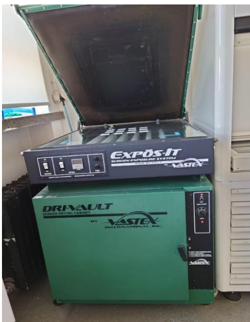
Slika 13 Uređaji za osvjetljavanje Expos-IT i sušenje DRI-VAULT 10, Vastex International.Inc.
