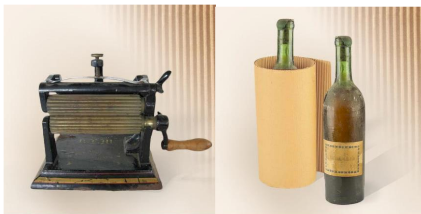
Slika 3. Stroj za nabore i boca omotana u valoviti karton
