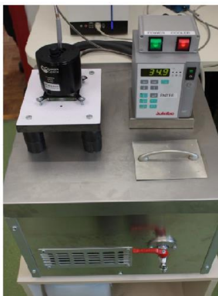
Slika 6. Uređaj za zagrijavanje/hlađenje uzoraka
