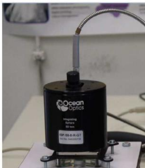
Slika 5. Ocean optics sfera za mjerenje kolorimetrijskih karakteristika
