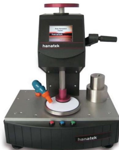
Slika 3. Uređaj Hanatek RT4 Rub and Abrasion Tester
