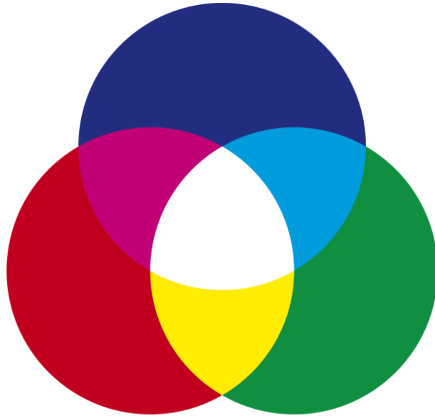
Slika 5. Aditivna sinteza boja
