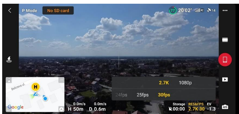
Slika 19. Prikaz sučelja Dji Fly aplikacije, opcija odabira rezolucije i fps-a u kojem je sniman video sadržaj za iradu projekta
