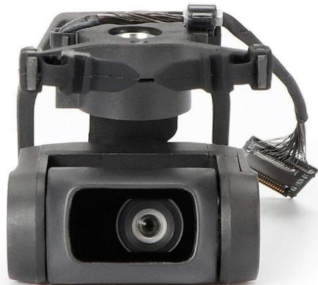
Slika 17. Kamera drona DJI Mavic Mini
