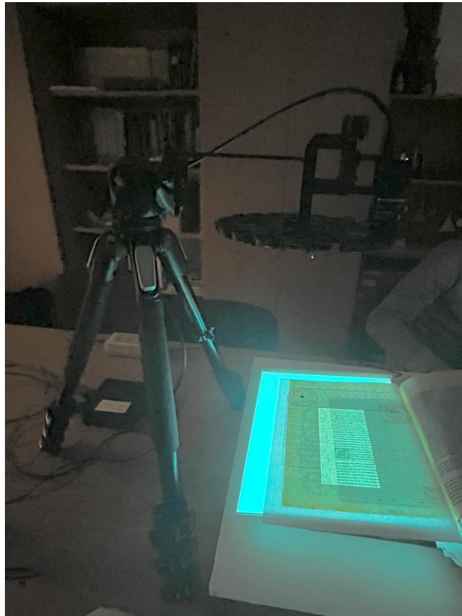
Slika 10: Sustav multispektralne kamere
