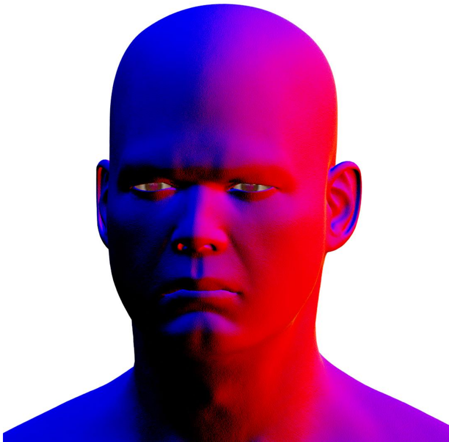
Slika 17: Normal mapa koja generira pore i druge nepravilnosti na površinama lažiranjem osvjetljenja
