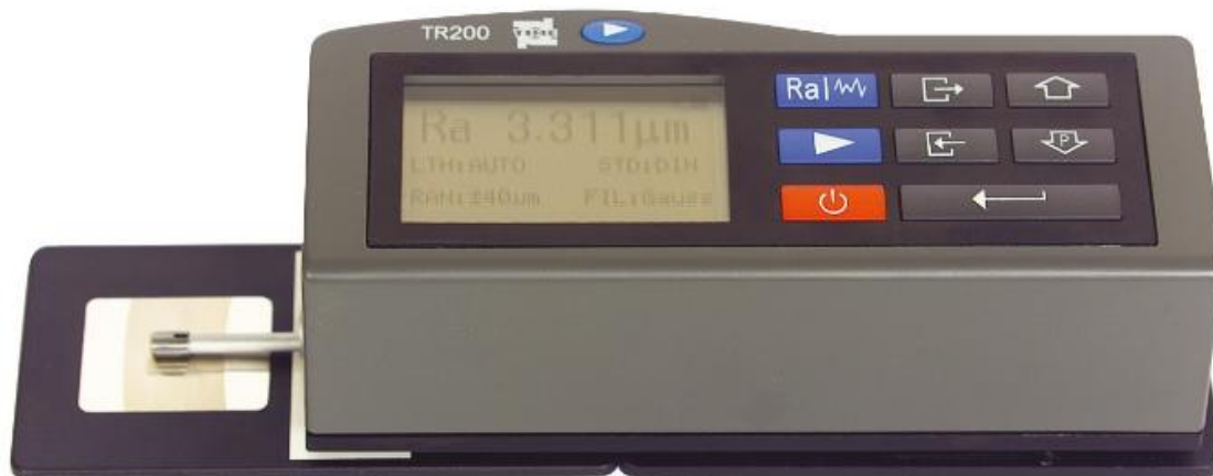
slika 22. Ručni tester za hrapavost TR200
