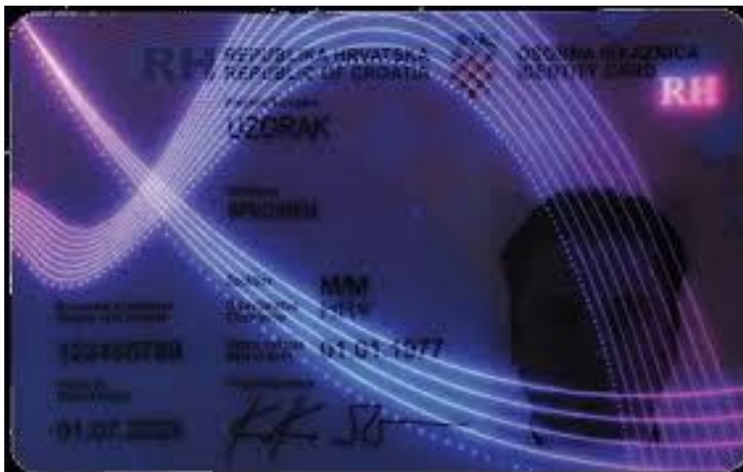
Slika 11 - Fluorescentni nadtisak na hrvatskoj osobnoj iskaznici
