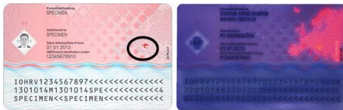
Slika 10 - Pozadinski tisak pod normalnim svjetlom (lijevo), Ista stranica pod UV svjetlom: – fluorescentna tinta (desno).
