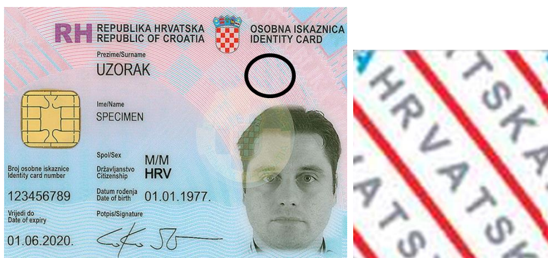
Slika 13- Elementi minitiska na hrvatskoj osobnoj iskaznici
