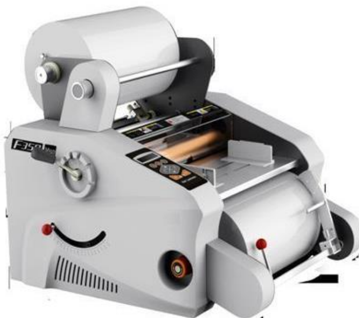
Slika 6 – Aparat za laminaciju sa folijom u obliku role..
