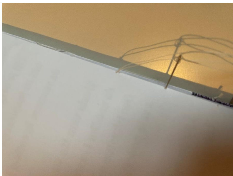
Slika 14. Šivanje iglom i koncem kroz hrbat
