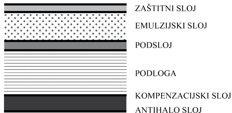
Slika 1: Ilustracija slojeva fotografskog filma
