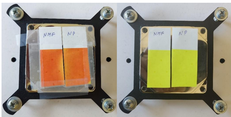
Slika 9. Vizualna prezentacija termokromnih otisaka dobivenih na različitim papirima za naljepnice korištenjem hladno-aktivirane OY-12 boje ispod 8^\circ\text{C} i iznad 20^\circ\text{C}
