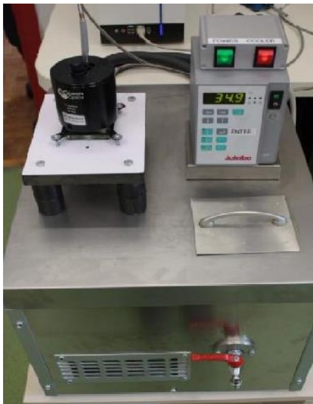
Slika 12. Uređaj za zagrijavanje ili hlađenje uzoraka (Izvor: https://eprints.grf.unizg.hr/3264/1/DB879_Penava_Ivan.pdf )
