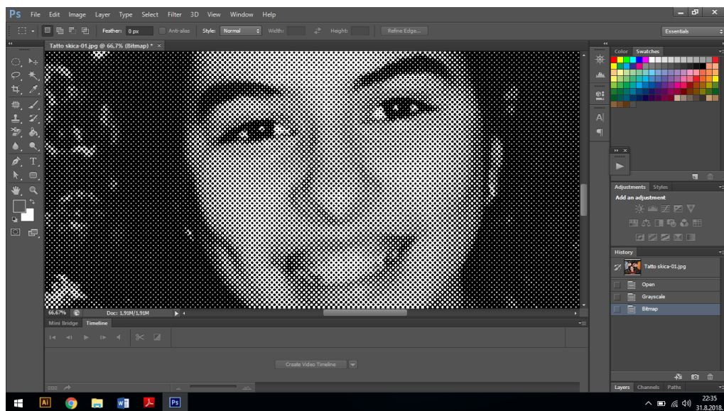
Slika 11. Fotografija iz rasterske grafike pretvorena u raster te spremna za ispis na film
