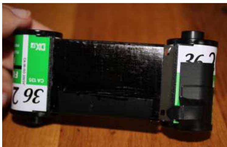
Slika 17. Provjera mogućnosti namatanja filma s brojačem
