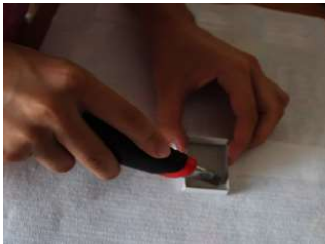
Slika 8. Izrezivanje otvora za film
