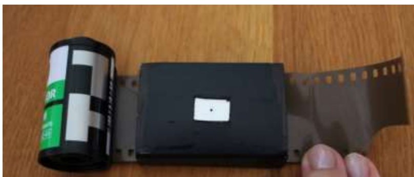
Slika 15. Postavljanje filma u cameru obscuru
