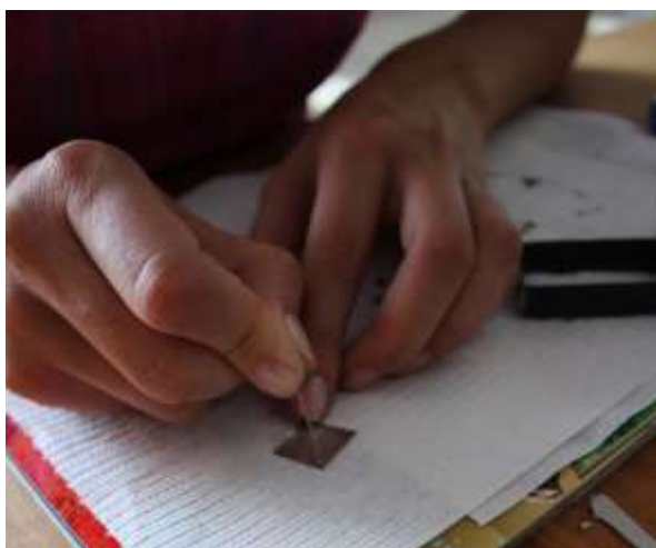
Slika 13. Bušenje rupice na limu iglom
