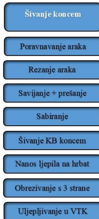
Slika 19. Pojednostavljena tehnološka shema (TUK)
