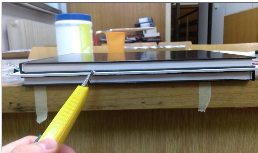
Slika 42. Hrapavljenje hrpta knjižnog bloka skalpelom
