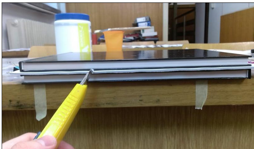
Slika 42. Hrapavljenje hrpta knjižnog bloka skalpelom
