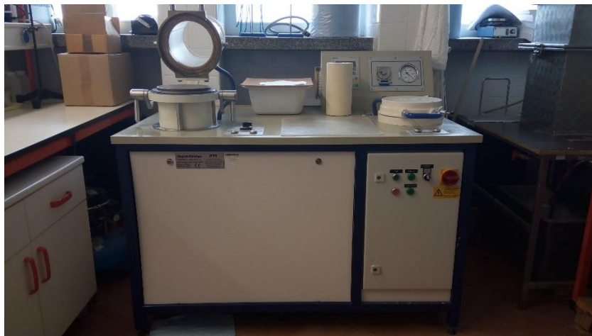
Slika 6. Automatski stroj za izradu laboratorijskih listova
