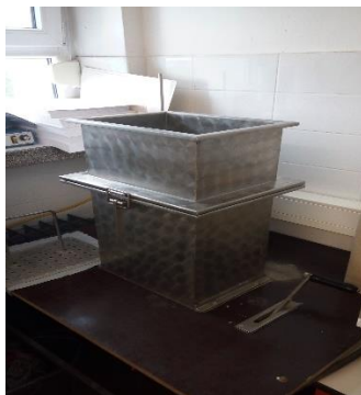
Slika 7. Ručni stroj za izradu listova
