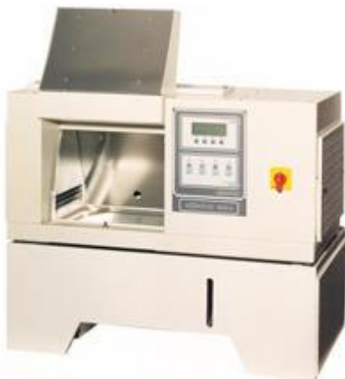
Slika 6. SOLARBOX 1500e uređaj korišten za starenje uzoraka
