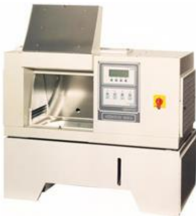
Slika 6. SOLARBOX 1500e uređaj korišten za starenje uzoraka
