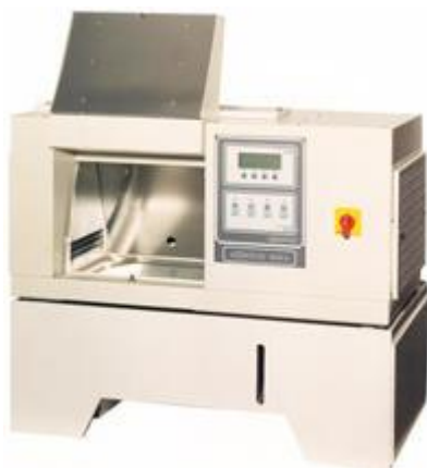
Slika 6. SOLARBOX 1500e uređaj korišten za starenje uzoraka
