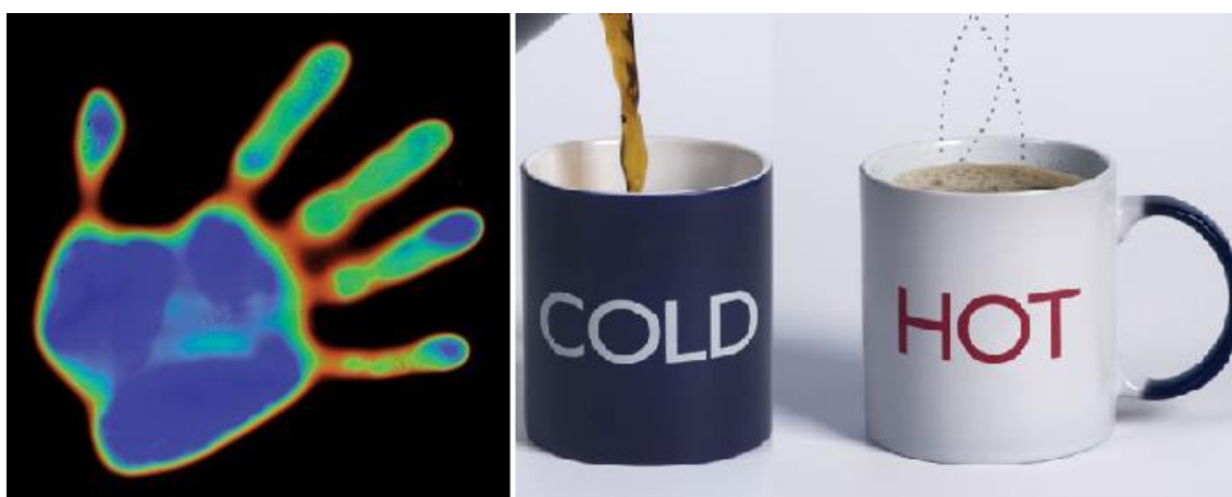
Slika 3. Razlika između termokromnih boja na bazi tekućih kristala (lijevo) i termokromnih boja na bazi leukobojila (desno)
