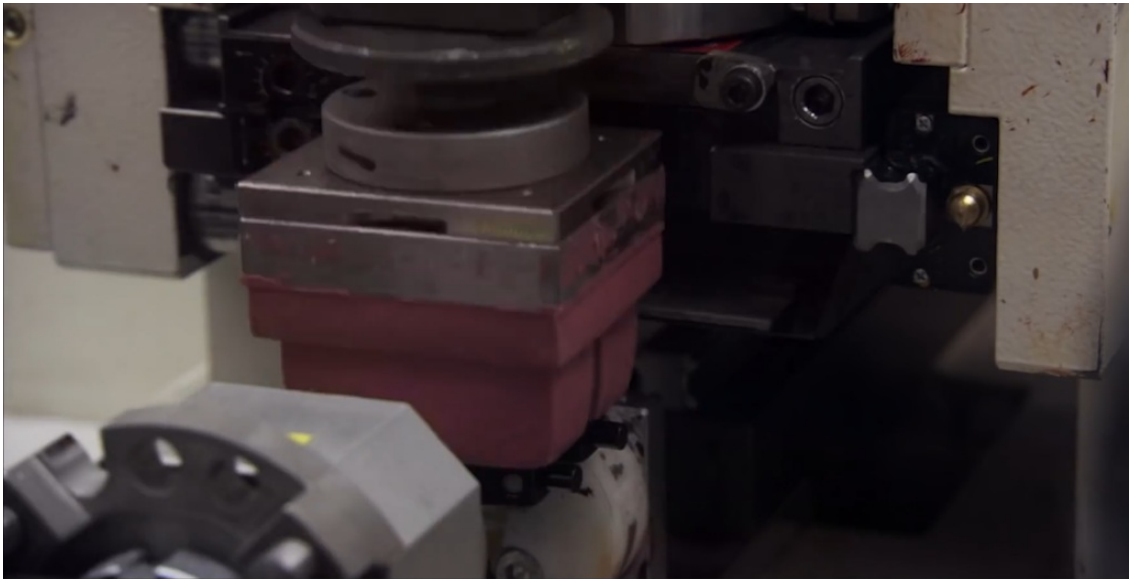
Slika 21. Prenošenje bojila na torzo figurice (izvor: https://www.youtube.com/National Geographic Megafactories LEGO/ )
