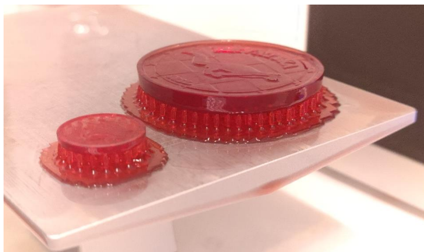
Slika 56 - Uklanjanje potporne strukture (izvor: privatno vlasništvo)
