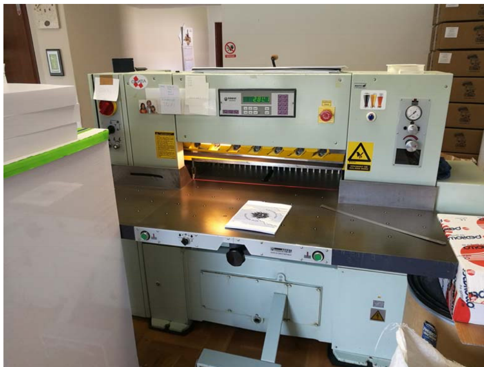
Slika 12: Rezanje knjižnog bloka
