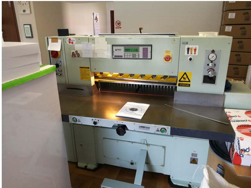
Slika 12: Rezanje knjižnog bloka
