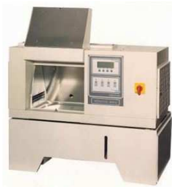
Slika 6. SOLARBOX 1500e uređaj korišten za starenje uzoraka
