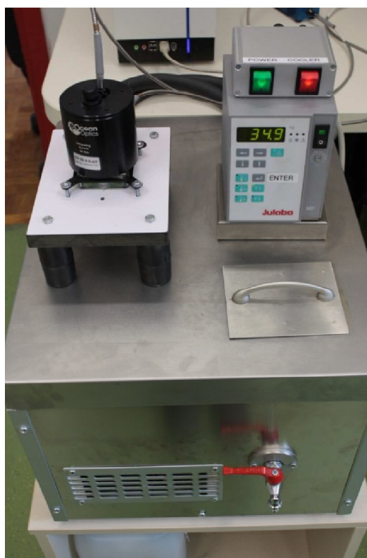
Slika 10. termički cirkulator, na metalnoj pločici položen je otisak i spektralni fotometar
