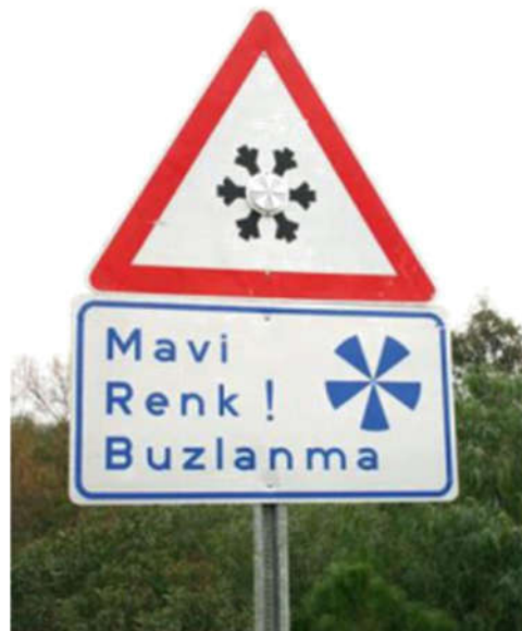
Slika 1.: Termokromni pokazatelj rizika od zaleđivanja ceste [2]
