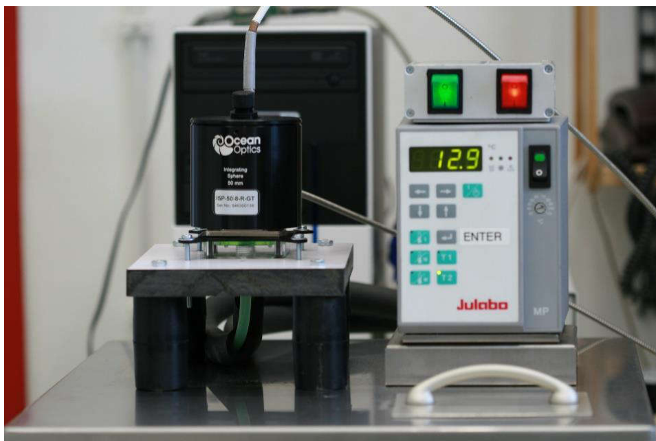
Slika 8. Mjerenje uzorka integracijskom sferom Ocean Optics ISP-50-8-R-GT na termostatskom cirkulatoru EK Water Blocks, EKWB d.o.o, Slovenija [4]
