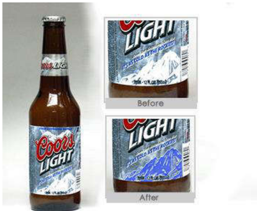
Slika 3.: Termokromna boja na etiketi piva [2]
