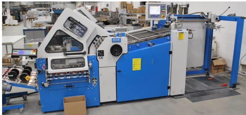
Slika 4. Stroj za savijanje tiskovnih podloga - Savijačica [12]
