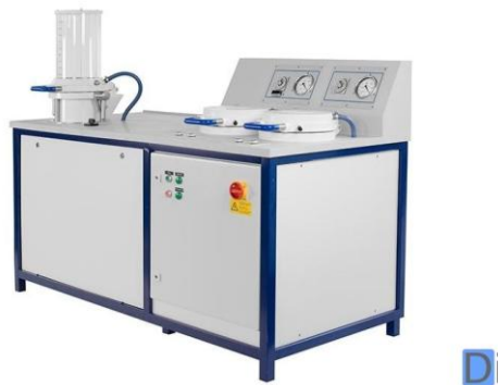
Slika 9. Uređaj za automatsku izradu laboratorijskog lista papira
