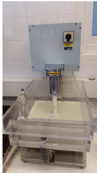
Slika 7. Shematski prikaz i fotografija flotacijske ćelije
