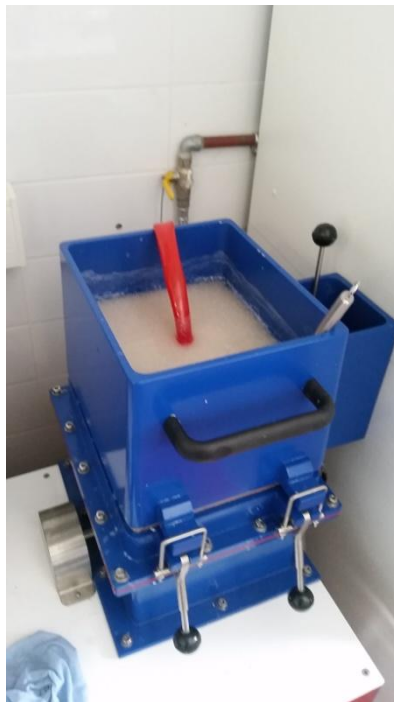
Slika 8. Uređaj za odvajanje ljepljivih čestica
