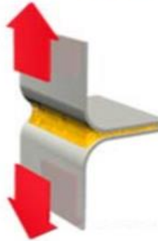
Slika 2.: Smjer djelovanja sila pri T-Pell testu;
