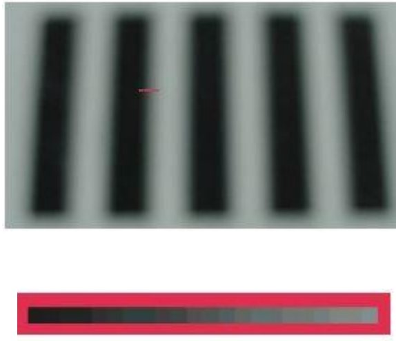
Slika 16: Nefokusirana slika i intenziteti piksela u jednom dijelu slike:
