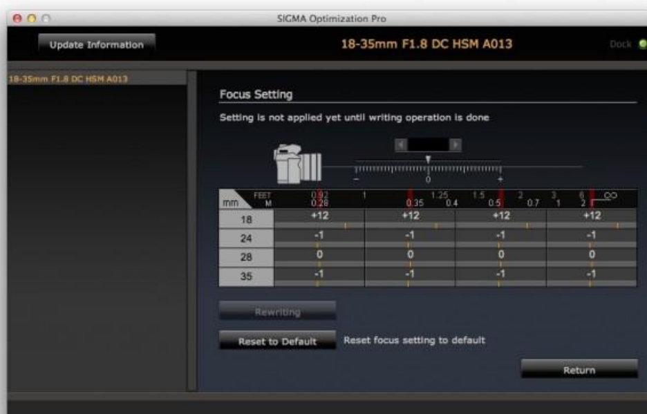
Slika 26: Fino podešavanje automatskog izoštravanja kod Sigminih objektiva preko računalnog programa (Izvor: http://www.photographybay.com/wp-content/uploads/2013/12/Sigma-Optimization-Pro-Focus-Adjustment-Menu-640x429.jpg )
