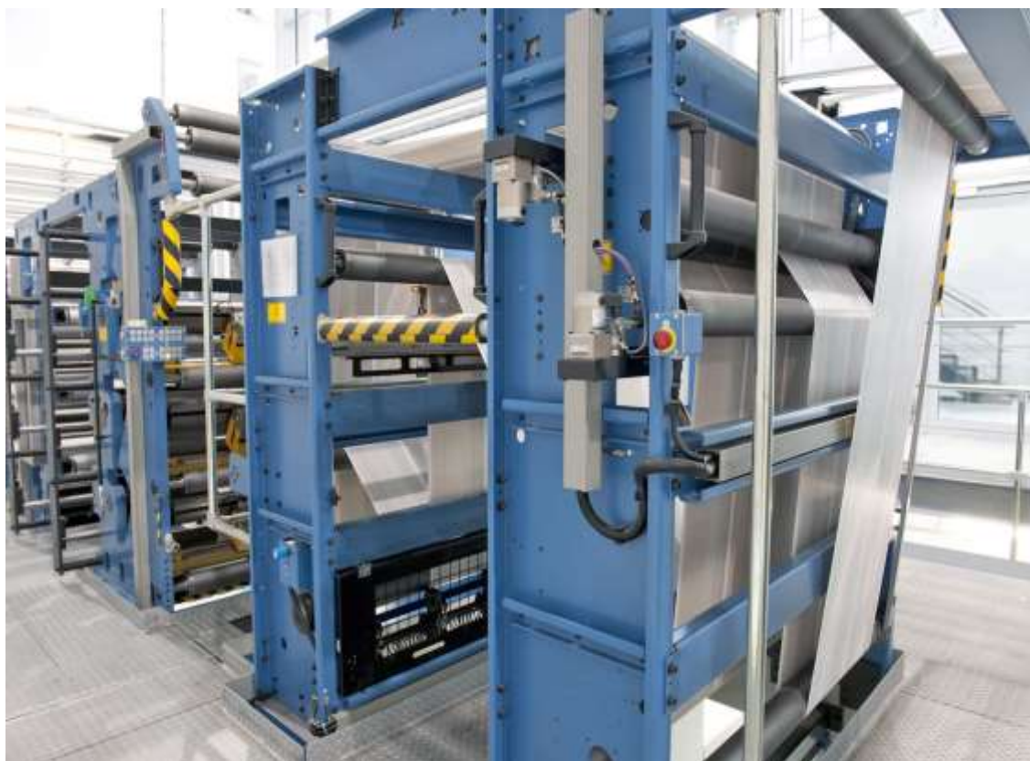
Slika 3. – COMMANDER – stroj za novinski tisak
