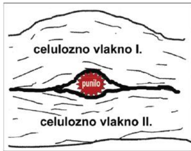
Slika 12. Čestice punila smještene između vlakana [10]
