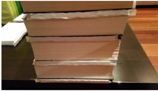
Slika 19. Sušenje knjižnih blokova pod utezima
