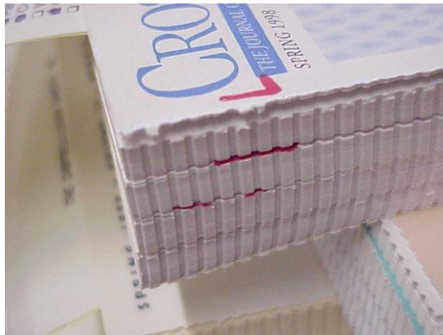
Slika 9. Mehanička obrada hrpta knjižnog bloka
