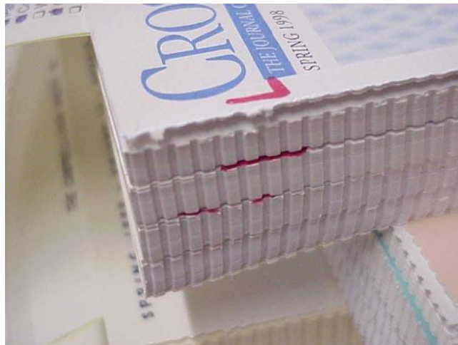
Slika 9. Mehanička obrada hrpta knjižnog bloka
