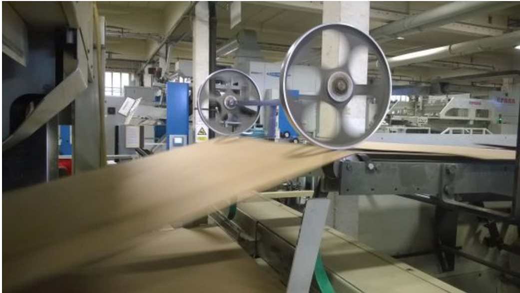
Slika 16 : Vodilice araka valovitog kartona na stroju Bobst Flexo 160 Vision (S-2)
