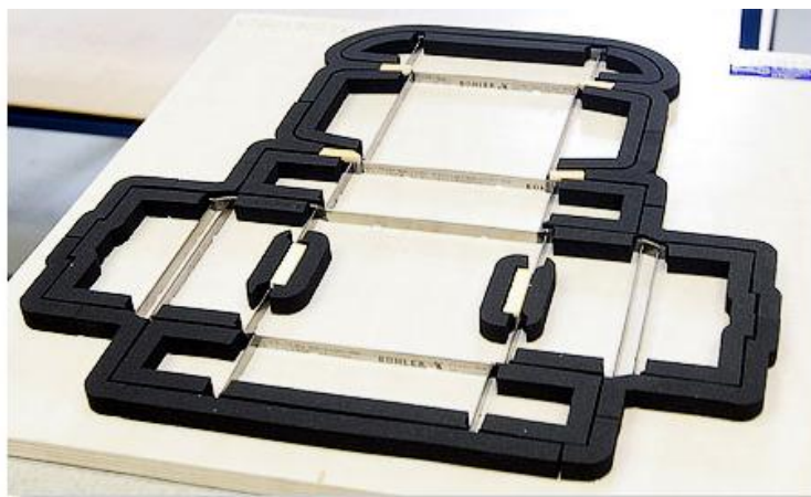
Slika 8. Prikaz plošne štance
