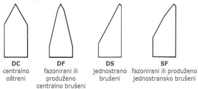
Slika 10. Oblik reznog ruba noževa za štancanje
