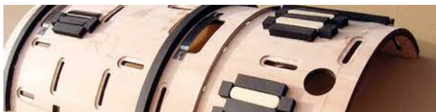
Slika 9. Prikaz rotirajuće štance
