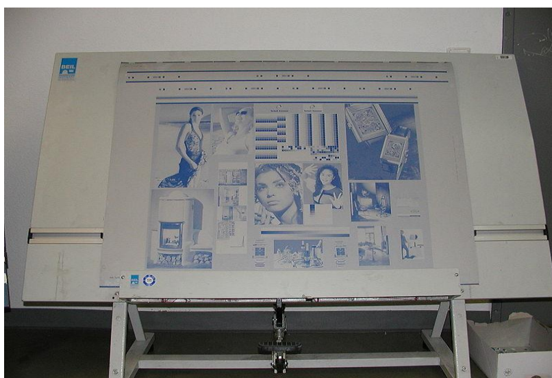
Slika 4: Prikaz tiskovne forme ofsetnog stroja
