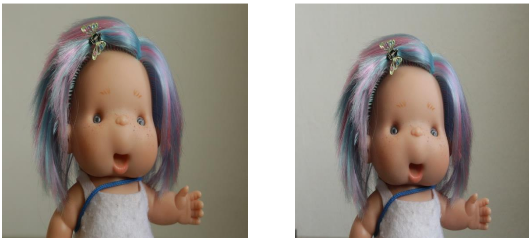
Slika 12. Šum na fotografiji snimljenoj sa ISO 3200 u jednakim uvjetima sa senzorom Full frame (lijevo) i sa senzorom APS-C formata (desno)
