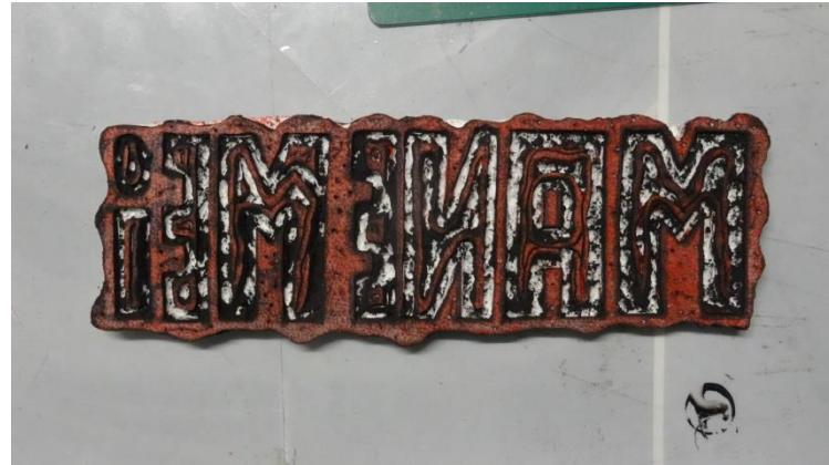
*Slika 15. Primjer tiskovne forme izrađene termičkim postupkom*
