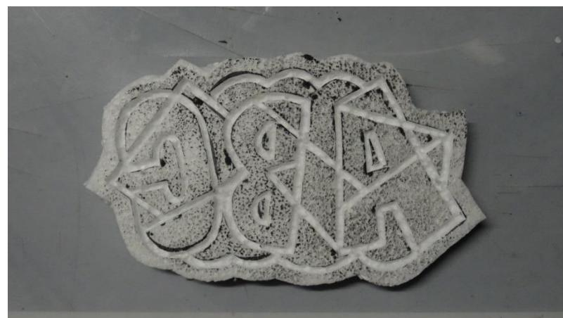
*Slika 14. Primjer tiskovne forme izrađene mehaničkim putem*
