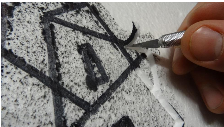
Slika 13. Izdublјivanje polistirena pomoću skalpela
