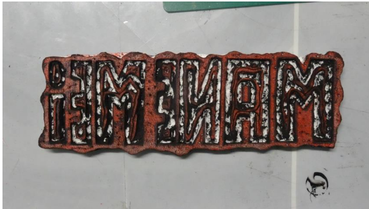
Slika15. Primjer tiskovne forme izrađene termičkim postupkom
