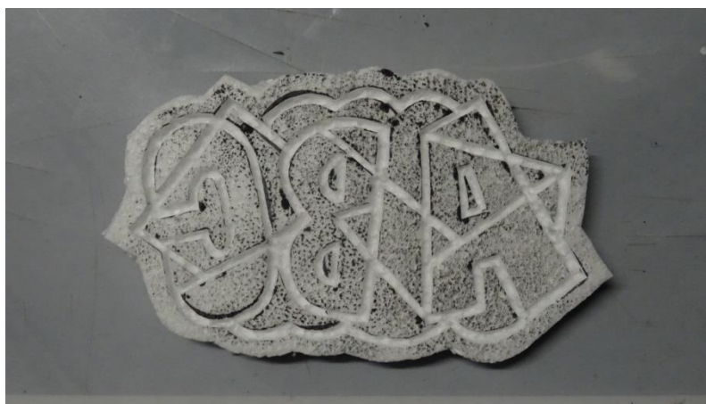
Slika 14. Primjer tiskovne forme izrađene mehaničkim putem
