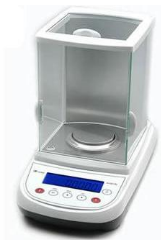
Slika 3.1.: Analitička vaga za mjerenje gramature papira
