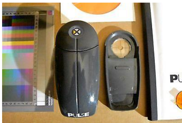
Slika 3.7.: Spektrofotometar X-Rite DTP20 Pulse
