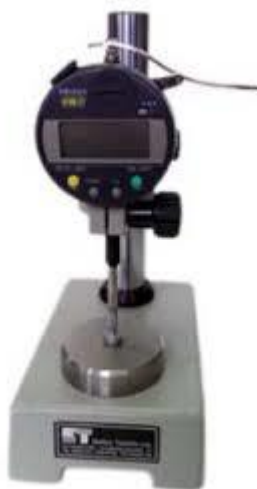
Slika 3.2.: Uređaj za mjerenje debljine papira- elektronički ručni mikrometar
