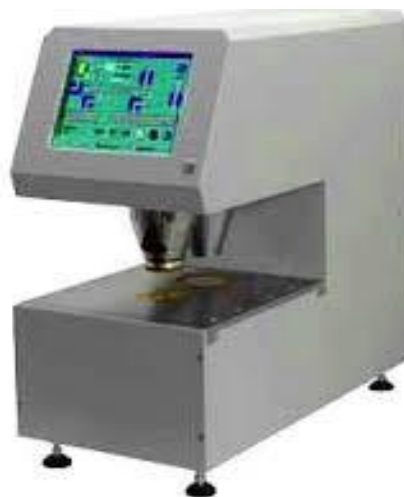
Slika 3.3: Uređaj za mjerenje glatкости papira PTI-Line Bekk
