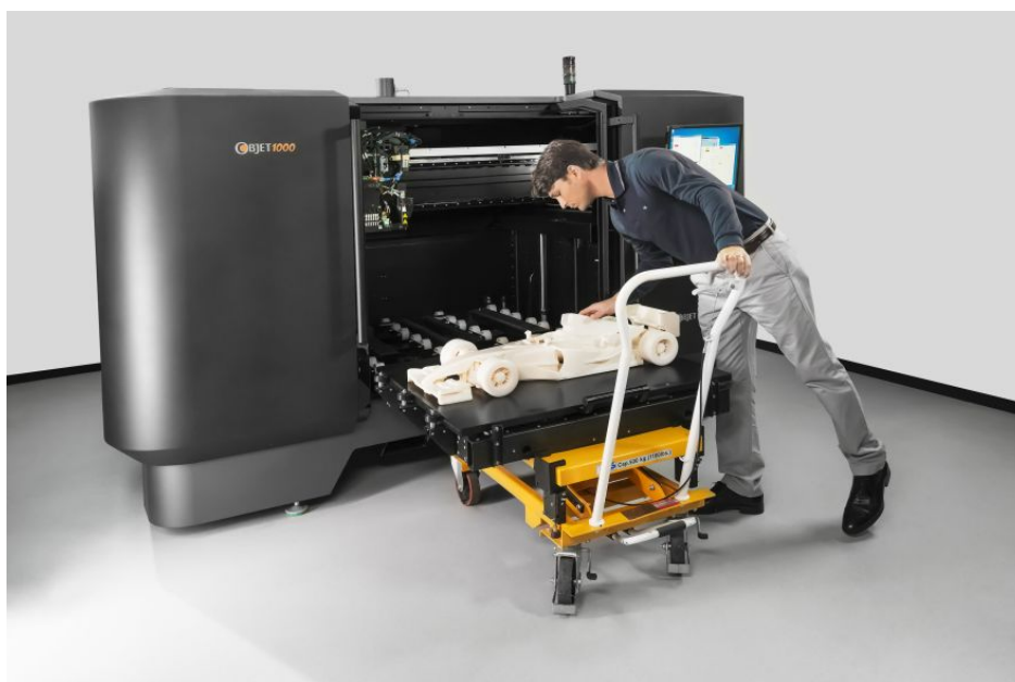
Slika 48. Industrijski 3D printer
