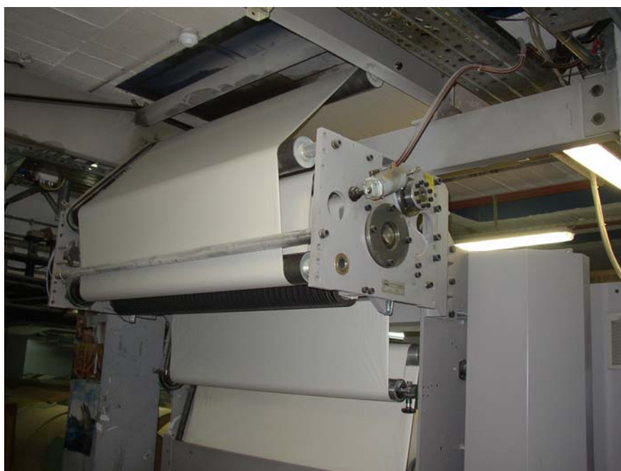
Fig. 16. Prolazak trake papira iz uređaja za izmjenu role prema stroju
