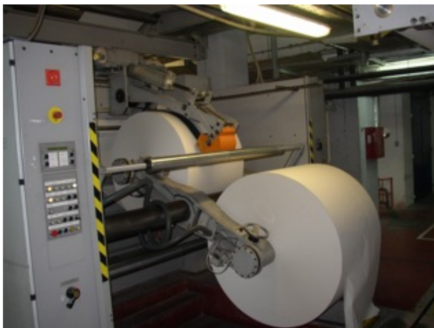
Fig. 15. Dvokraki uređaj za izmjenu role papira tipa Unipaster 1270 FR
