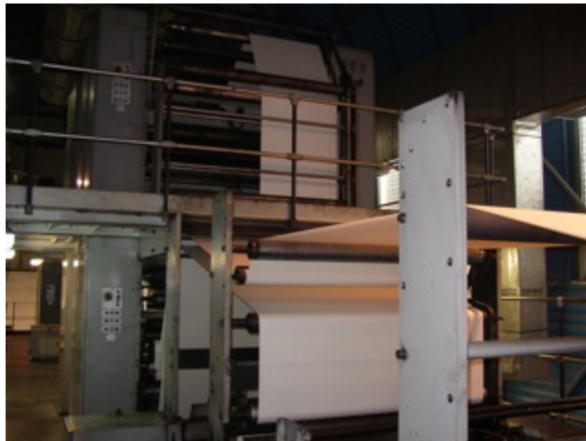
Fig. 23. Vođenje trake papira sustavom valjaka i rolica
