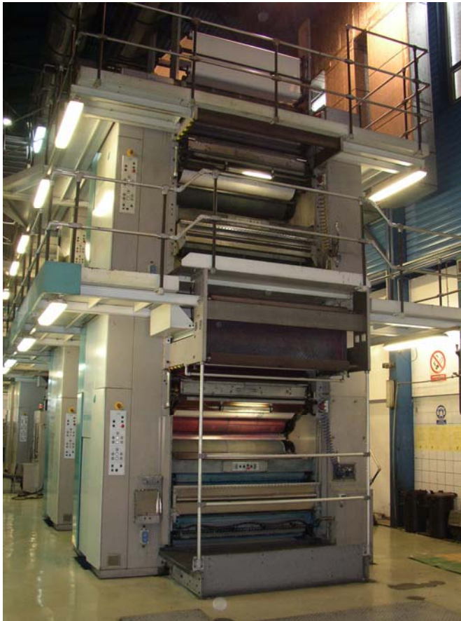
Fig. 17. Tiskovna jedinica (toranj) novinske rotacije Geoman
