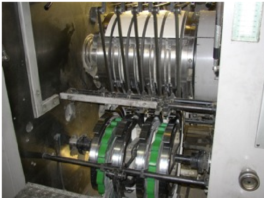
Fig. 24. Sustav savijanja i izlaganja novina
